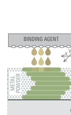
Winzige Bindemitteltropfen werden durch viele Düsen selektiv lokal und schichtweise auf Metallpulver aufgebracht. Sie kleben das Pulvermaterial zusammen.
