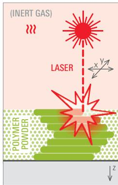
Mittels eines beweglichen Laserstrahls wird Polymerpulver schichtweise selektiv lokal gesintert und verfestigt damit einen Querschnitt des Bauteils.
