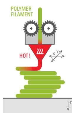
Drahtförmiger Kunststoff, sogenanntes Filament, wird in einer Düsen Einheit plastifiziert und schichtweise selektiv lokal dosiert.
