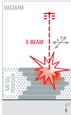
Mittels eines beweglichen Elektronenstrahls wird Metallpulver schichtweise selektiv lokal aufgeschmolzen und es verfestigt sich damit ein Querschnitt des Bauteils.
