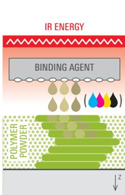
Kleinste Flüssigkeitströpfchen werden lokal auf eine Polymerpulverschicht aufgebracht. Sie erhöhen oder unterdrücken die Wärmeabsorption des Materials. Eine integral wirkende Infrarotquelle schmilzt das pulverförmige Ausgangsmaterial lokal auf.
