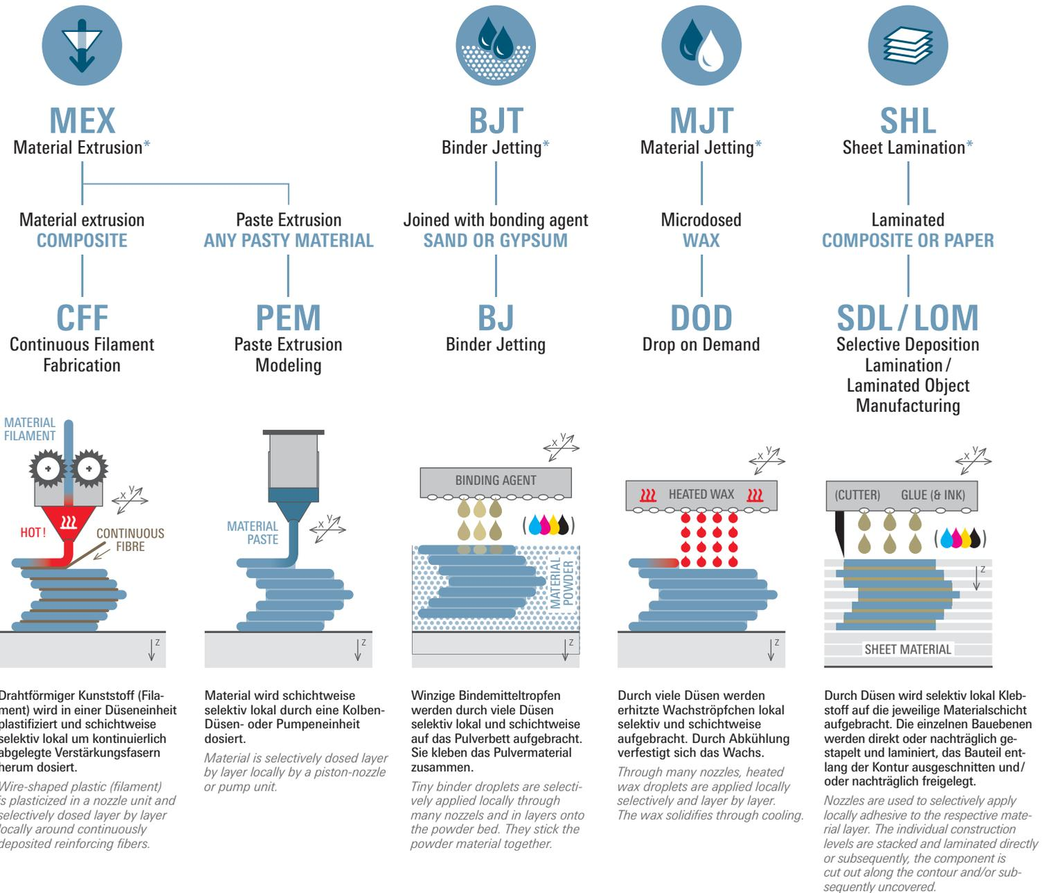
Für alle Verfahren gilt: Durch den schichtweisen selektiven Ablauf entstehen dreidimensionale Strukturen.
