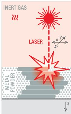
Mittels eines beweglichen Laserstrahls wird Metallpulver schichtweise selektiv lokal aufgeschmolzen und verfestigt damit einen Querschnitt des Bauteils.
