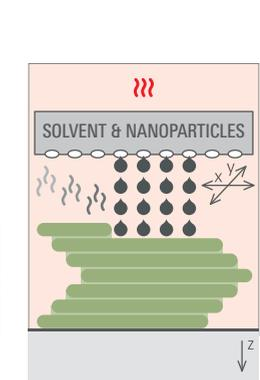
Eine Metallpartikel-Lösemittelflüssigkeit wird in einer Düsen-einheit selektiv lokal dosiert. Das Lösemittel verdunstet und die Nanopartikel verbinden sich.
