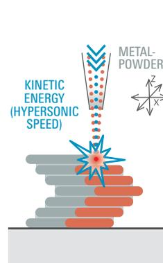
Materialpulver wird mit sehr hoher kinetischer Energie schichtweise aufgebracht. Endkonturnahe Bauteile entstehen. Materialkombinationen sind möglich.
