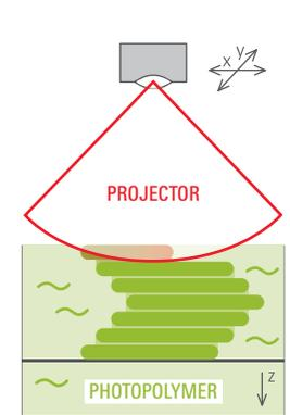
Mittels eines Projektors wird ein Photopolymer schichtweise belichtet. Material, das belichtet wird, polymerisiert lokal aus und verfestigt sich.
