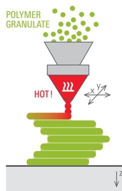
Kunststoffgranulat wird in einer Düsen Einheit plastifiziert und schichtweise selektiv lokal dosiert.
