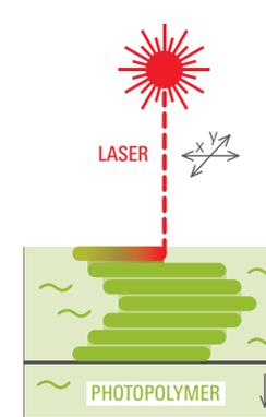
Mittels eines beweglichen Laserstrahls wird ein dickflüssiges Photopolymer schichtweise selektiv lokal auspolymerisiert und verfestigt sich dort.
