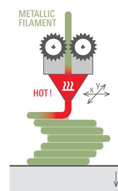
Drahtförmiger metallhaltiger Kunststoff, sogenanntes Filament, wird in einer Düsen-einheit plastifiziert und schichtweise selektiv lokal dosiert.
