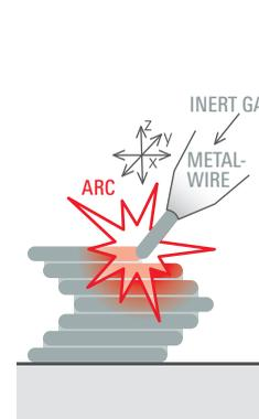
Metalldraht wird im Lichtbogenschweißverfahren geschmolzen und schichtweise lokal aufgetragen, um schnell große endkonturnahe Metallstrukturen zu erzeugen.
