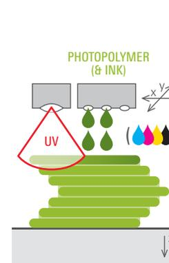
Durch viele Düsen werden kleinste Photopolymertröpfchen lokal und schichtweise aufgebracht. Direkt im Anschluss wird das dickflüssige Photopolymer durch UV-Licht ausgehärtet.
