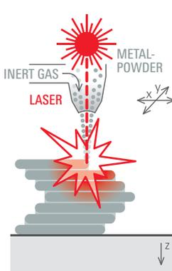
Material wird aufgebracht und simultan durch einen Laserstrahl aufgeschmolzen. Das folgende Erstarren der Schmelze generiert neue Schichten, die über- und nebeneinander angeordnet werden.
